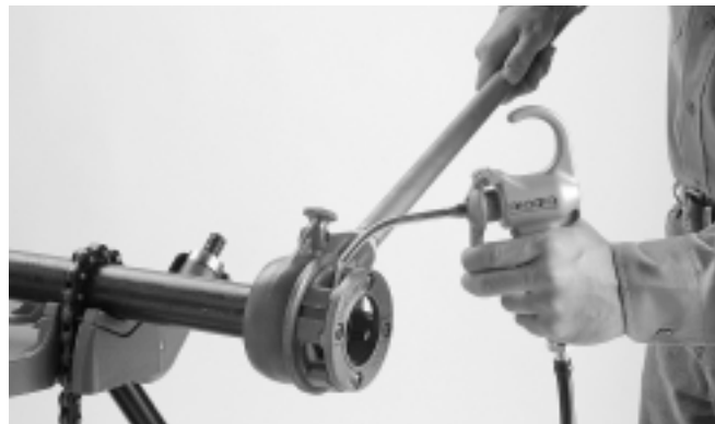
Figure 4 – Application de l'huile de coupe
